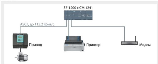
Протокол ASCII позволяет устанавливать соединения между S7-1200 и другими контроллерами, компьютерами и приборами, способными поддерживать последовательный обмен данными через интерфейсы RS 232, RS 422 или RS 485. Структура сообщений и параметры их передачи могут свободно конфигурироваться, обеспечивая высокую гибкость получаемых решений.
