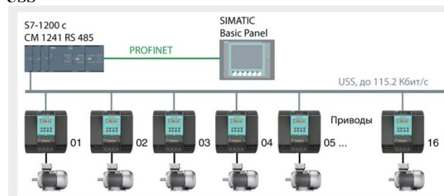
Протокол USS позволяет выполнять обмен данными между программируемым контроллером S7-1200 и приводами серий SINAMICS и MICROMASTER. К одному коммуникационному модулю CM 1241 может быть подключено до 16 приводов, к одному контроллеру S7-1200 – до 48 приводов. Необходимый набор команд для управления обменом данными интегрирован в STEP 7 Basic от V10.5 и выше. Скорость обмена данными может достигать 115.2 Кбит/с.
