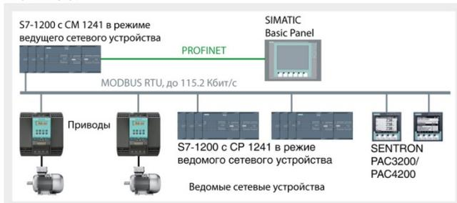
Для обмена данными по протоколу MODBUS RTU:
