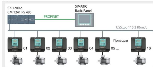
Протокол обмена данными с приводами через последовательный интерфейс RS 485. Позволяет управлять подключенными приводами, считывать и записывать в них различные параметры.
