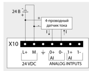
Подключение датчиков силы тока на примере канала 0
