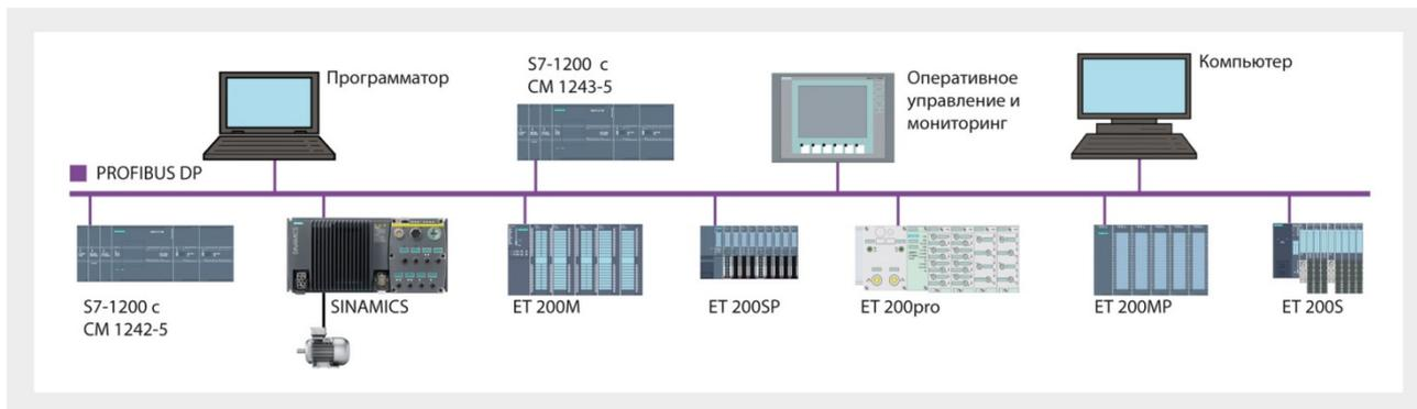
Модуль CM 1243-5 позволяет подключать программируемый контроллер S7-1200 к сети PROFIBUS DP в режиме ведущего сетевого устройства DP V0/V1. К одному модулю CM 1243-5 может быть подключено до 32 ведомых DP устройств, обслуживающих до 512 модулей ввода-вывода. Функции ведомых DP устройств способны выполнять:
