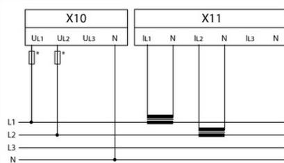
Без трансформаторов напряжения
