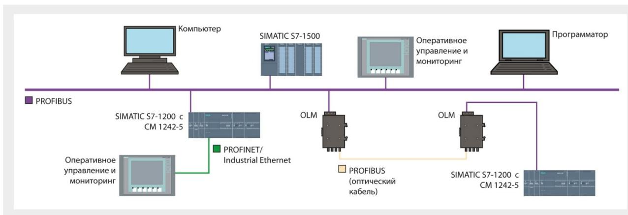
Коммуникационный модуль CM 1242-5 позволяет использовать программируемый контроллер S7-1200 в режиме интеллектуального ведомого устройства PROFIBUS DP. Функции ведущих сетевых устройств DP V0/V1 способны выполнять:
