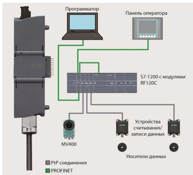
Коммуникационный модуль RF120C для построения систем идентификации на базе программируемых контроллеров S7-1200.
