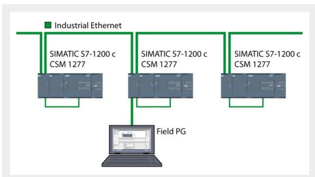
Модуль CSM 1277 выпускается в компактном пластиковом корпусе шириной 45 мм и характеризуется следующими показателями:
