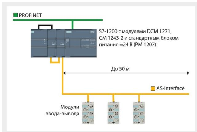
Разделительный модуль DCM 1271 позволяет использовать для питания сети AS-Interface стандартный блок питания =24 В:
