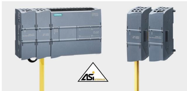
Коммуникационный модуль CM 1243-2 позволяет использовать программируемый контроллер S7-1200 в режиме ведущего устройства сети AS-Interface:
