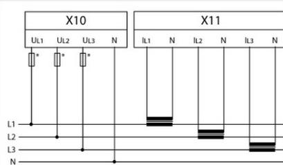
Без трансформаторов напряжения
