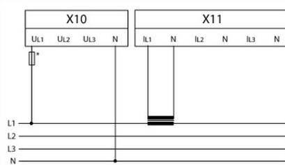
Без трансформаторов напряжения
