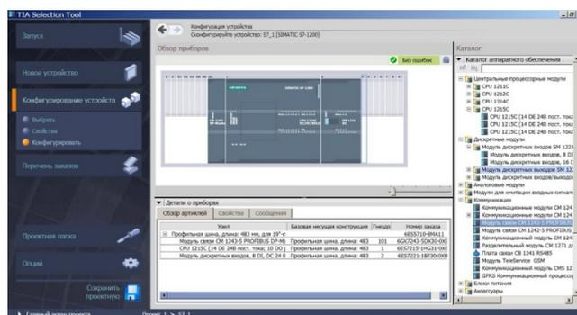
Коммуникационные модули устанавливаются слева от центрального процессора и подключаются к внутренней шине контроллера через встроенный в каждый модуль соединитель. К одному центральному процессору допускается выполнять подключение до трех коммуникационных модулей.
