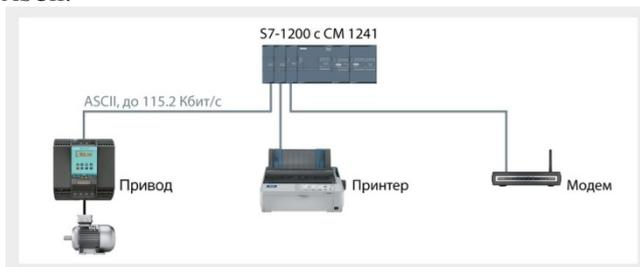
Для подключения систем других производителей, использующих простейшие протоколы обмена данными. Например, протоколы со стартовыми и стоповыми символами, контрольными суммами и т.д. Интерфейсные сигналы могут вызываться и управляться из программы пользователя.
