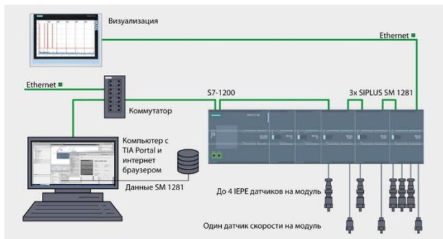
Модуль SIPLUS CMS1200 SM 1281 позволяет использовать контроллер S7-1200 для построения систем мониторинга состояний производственных машин и установок, своевременно выявлять опасные изменения в их состоянии, предпринимать превентивные меры по исключению поломок и аварий. Он может быть использован для мониторинга состояний:
