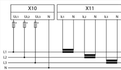
Без трансформаторов напряжения
