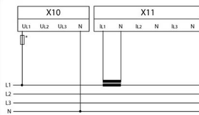
Без трансформаторов напряжения
