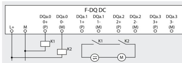
Подключение внешних контакторов с разделным управлением через Р- и М-ключи одного выхода
