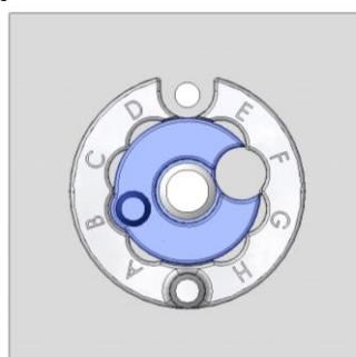
La posición de los pasadores determina la asignación de las letras y las cifras. En este ejemplo, los discos codificadores tienen la asignación 6-B. The position of the pins is decisive for the assignment of the letters and numbers. Here, for example, the coding disks have the assignment 6-B
