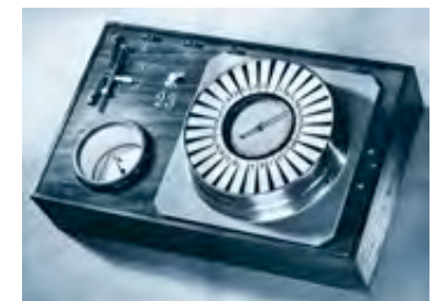
1847 konstruerade Siemens den första fungerande visartelegrafan.
