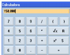
Se um campo de entrada requer uma entrada numérica, pode-se optar pelo uso da calculadora pressionando-se o  **sinal de igual (=)** no teclado. Se já houver um valor no campo de entrada, p. ex. 100, então esse valor será transportado para a janela da calculadora.
