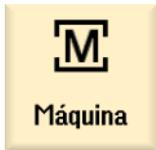
A área de operação "Máquina" é chamada ao ser pressionada a softkey horizontal 1 "Máquina".
