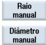
Pressionando-se a softkey horizontal 4 "Medir ferramenta" e a softkey vertical 2 "Raio manual" ou "Diâmetro manual" (na área de operação "Máquina" e modo de operação "JOG") é aberta a seguinte tela de entradas.
