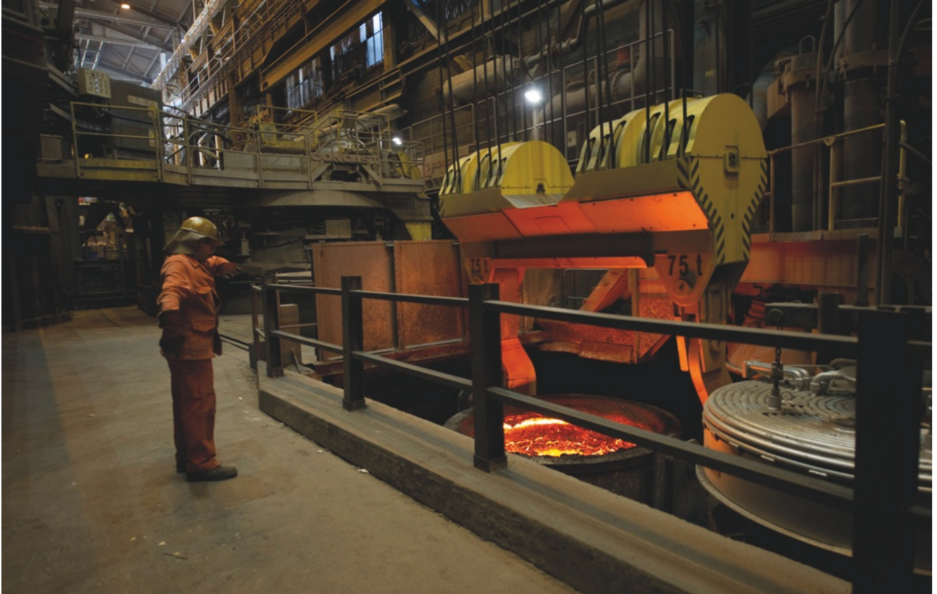
Das Roheisen fließt in Gießpfannen, in denen es ein Kran vom Hochofen zur Gießmaschine transportiert.
