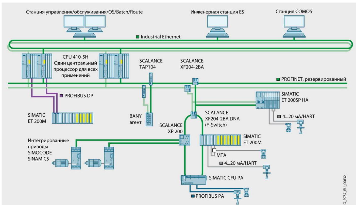
PROFINET сочетает в себе преимущества PROFIBUS с новейшими технологиями Ethernet. PROFINET поддерживает простую настройку гибко адаптируемых сетей и обеспечивает надежную и безопасную связь в реальном времени.
