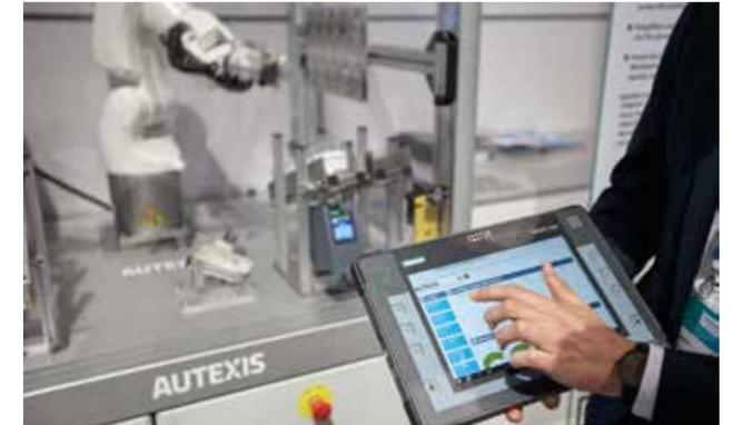
Le système de préparation des commandes est piloté facilement avec deux Simatic Panel.
