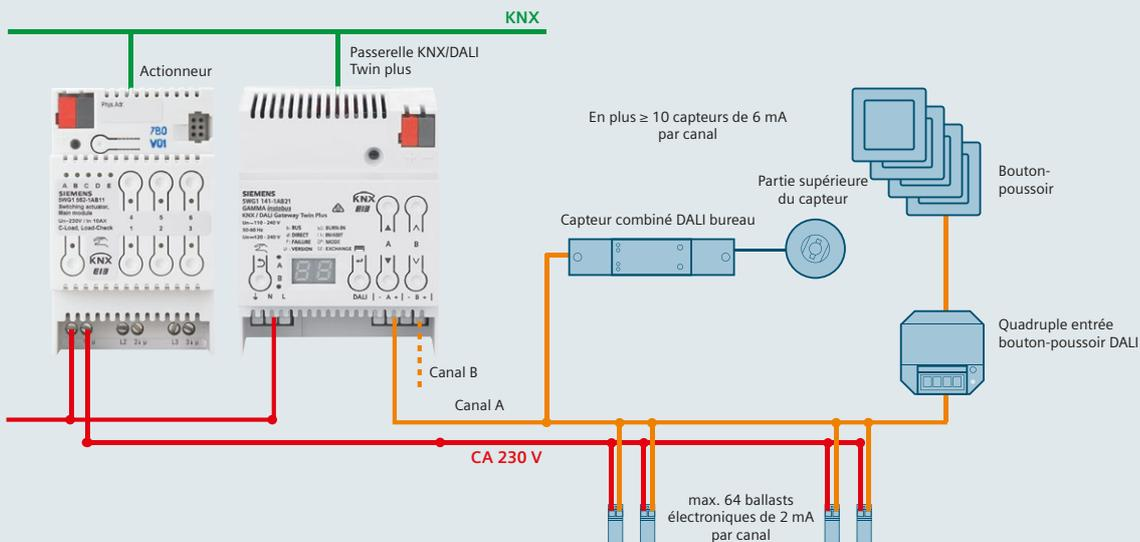
Les lampes dotées de ballasts électroniques ont habituellement besoin d'un courant de repos lorsque l'éclairage est éteint ou en mode veille. Cette consommation énergétique s'additionne et peut être économisée par un arrêt automatique de l'alimentation pour les ballasts électroniques à l'aide de la passerelle KNX/DALI Twin plus.
