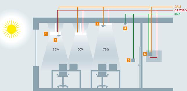
KNX permet d'intégrer totalement l'installation d'éclairage DALI dans un système d'automatisation du bâtiment par le biais d'une interface DALI ou KNX. L'utilisation de capteurs de luminosité possédant une interface DALI intégrée est notamment une approche efficace pour les lampes à suspension étant donné que le capteur de la lampe ne doit être raccordé qu'à DALI.
