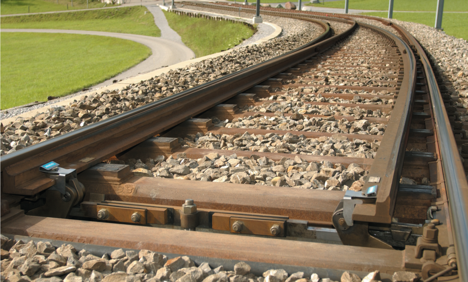
In eine Weiche installierter Klinkenverschluss
