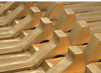
Verschlussklinken nach der Bearbeitung in unserer Schweizer Fertigung
