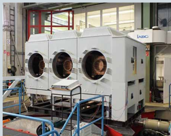
Рис. 54 Распределительное устройство HB3 во время проведения сейсмических испытаний
