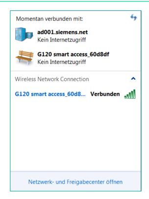
Mit Ihrem Mobilgerät im Wi-Fi-Netz SINAMICS G120 Smart Access finden. Standard-Passwort\* eingeben und »Verbinden« drücken
