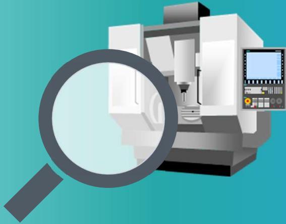
Analyze MyMachine /Condition permite al operario generar una **huella digital mecánica** de su máquina CNC para poder identificar desviaciones potenciales en un estadio temprano, prevenir fallos de máquina y optimizar la operatividad de la máquina.
