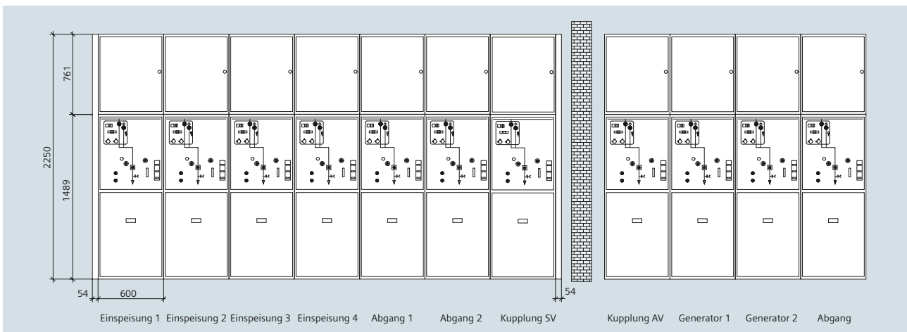
Abb. 5/3: Frontansicht der Mittelspannungs-Schaltanlagen NXPLUS C für die Gegenstation im 10-kV-Konzept
