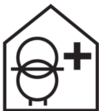
Figura 16 – Símbolo del transformador de aislamiento diseñado según la IEC 61558-2-15
