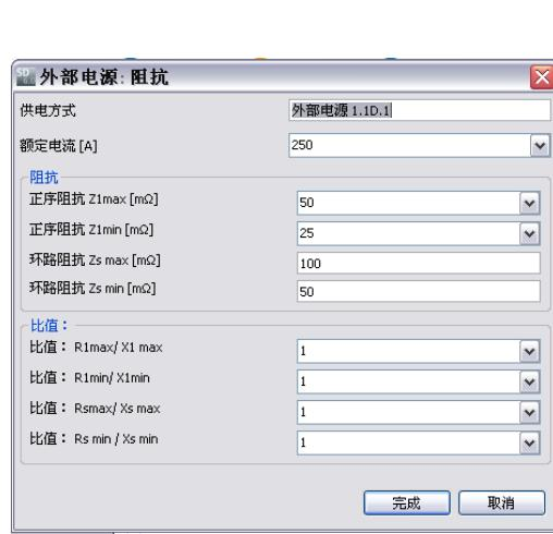
依赖于不确定电源定义，通过阻抗、环路阻抗或者短路电流，设备对话框上显示相应的数据。
