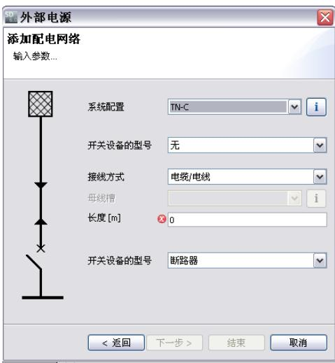
■ 在插入向导的第三个窗口，输入不确定网络电源的基本参数，3种不同输入电源参数在第三个窗口都相同。也描述了不同菜单图标做出不同的选型计算。
