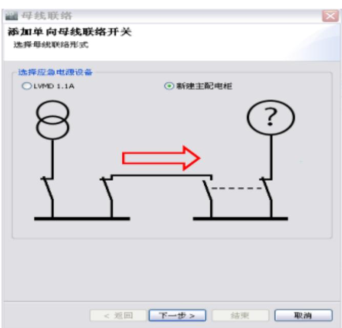
用于方向母联的插入向导第一个窗口，确定定向母联的能源流向，比如，无论新主配电还是已经存在的主配电都可以作为应急供电系统。
