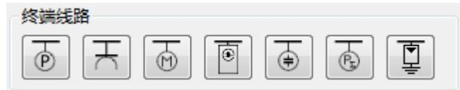
通常，终端线路通过如下方式添加到网络图上，在低压主配电或者子配电上，通过移动鼠标指针找到合适插入位置（黄色正方形），按下和拖动鼠标，最后释放鼠标就在插入点添加了终端线路。
