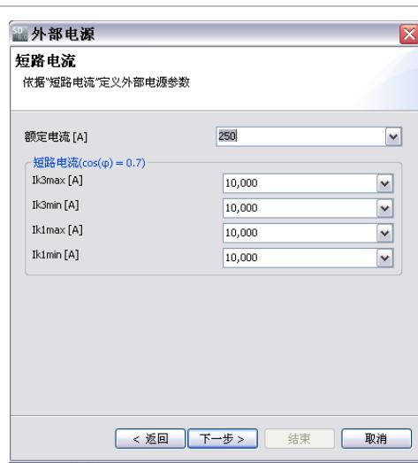
当通过短路电流定义不确定电源时，可以设定如下参数：
