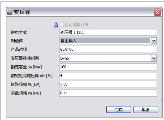
通过设置“制造商”为“自由输入”，西门子变压器参数就不能选择了。这意味着可以输入用户特定的变压器参数。通过工具提示显示可输入的范围值。虽然，这也意味着变压器被排除在自动选型之外，也就是，“自动选型计算”被移除或者通过在它旁边有个挂锁符号 。这个挂锁符号也会显示在单线图上，很明显让人知道变压器不会再自动选型。
