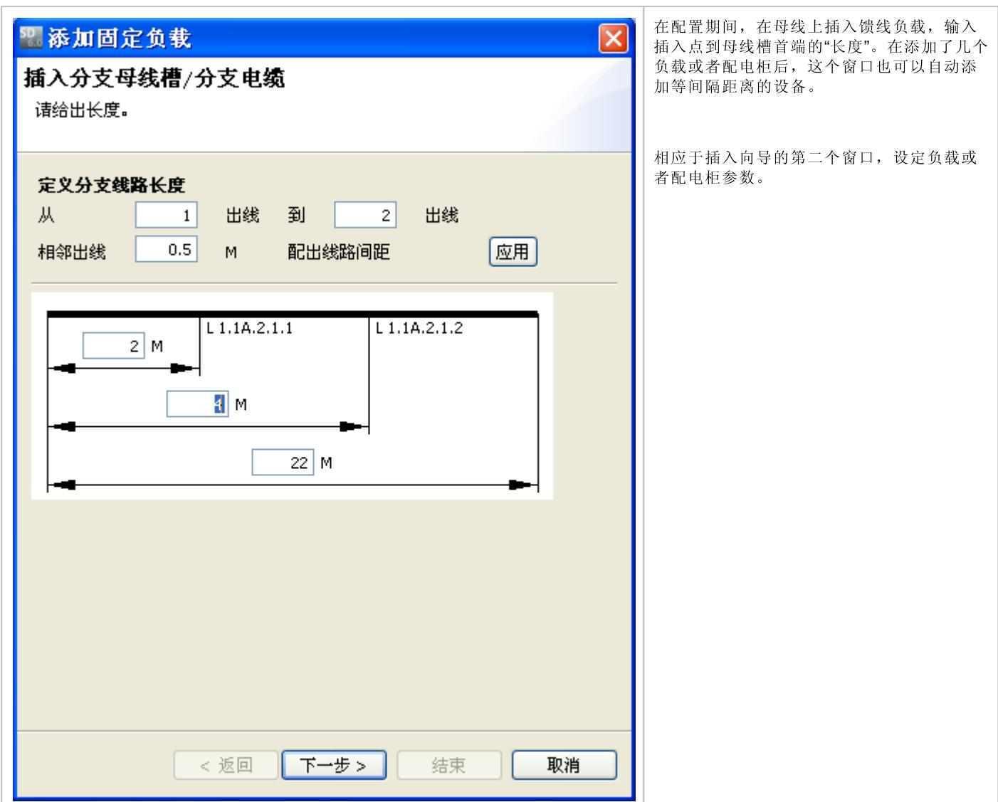
在配置期间，在母线上插入馈线负载，输入插入点到母线槽首端的“长度”。在添加了几个负载或者配电柜后，这个窗口也可以自动添加等间隔距离的设备。
