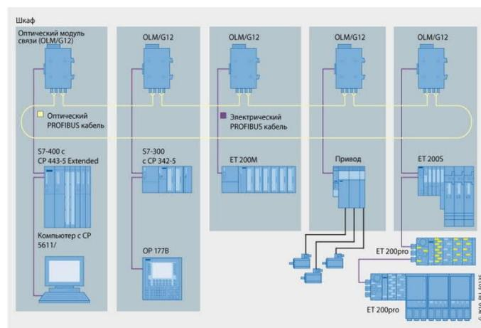
модулей IM 151-1 FO, IM 151-7 CPU FO и других. При использовании пластикового оптического кабеля расстояние между двумя соседними станциями может достигать 50 м. При использовании PCF кабеля – 300 м.
