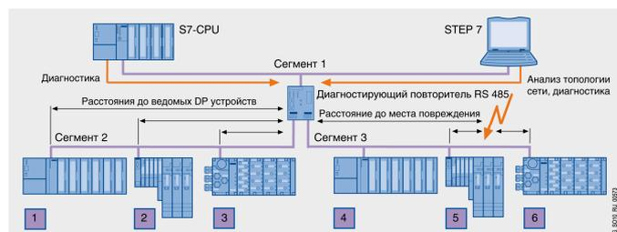
Соединение отдельных сегментов в единую сеть выполняется с помощью повторителей RS 485. Каждый повторитель обеспечивает гальваническое разделение подключенных сегментов и регенерацию передаваемых между ними сигналов. В одной сети допускается использование до 9 последовательно включенных повторителей. Повторители RS485 “прозрачны” для обмена данными и не требуют никакого программного конфигурирования.
