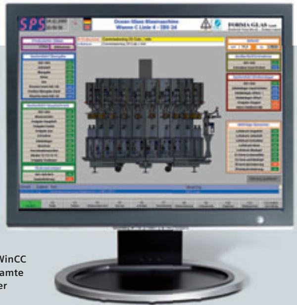
Mit der mehrsprachigen Bedienoberfläche unter WinCC flexible lässt sich der gesamte Prozess noch komfortabler einrichten und bedienen
