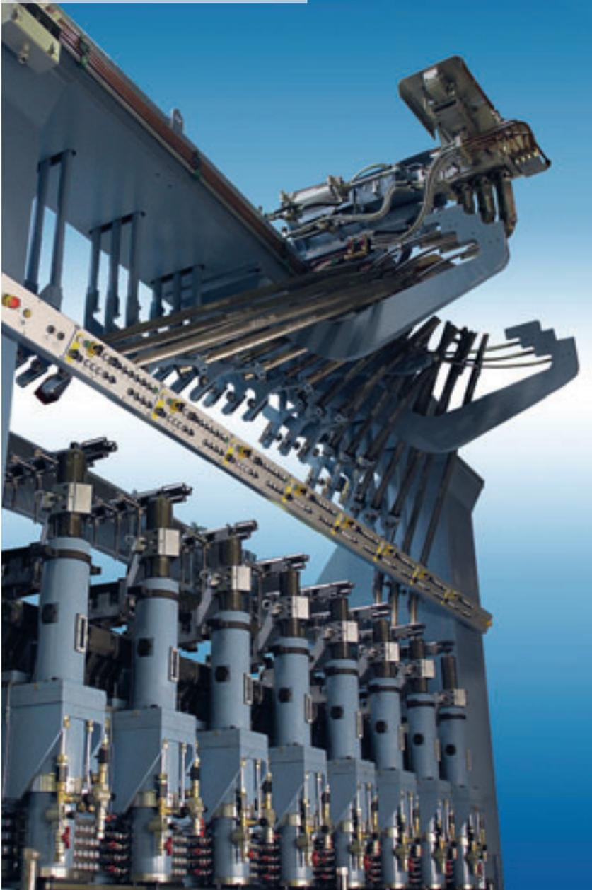
Als Trendsetter in der Glasindustrie hat Sklostroj eine neue ISS-Maschine vorgestellt. Ausgestattet mit modernster Automatisierungstechnik, wurden mechanische Bewegungskopplungen sowie anwendungsspezifische Steuerungs- und Regelungseinrichtungen durch standardisierte mechatronische Lösungen ersetzt.
