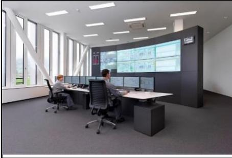
Siemens-Technologie sorgt bei der Renergia Zentralschweiz für effiziente und wirtschaftliche Prozesse. Der gesamte Betrieb wird mit dem Prozessleitsystem PCS7 und Simatic-Steuerungen abgewickelt: Von den Verbrennungsöfen über die Prozessdampf-Herstellung bis hin zur Behandlung der Rauchgase und Wärmerückgewinnung.
