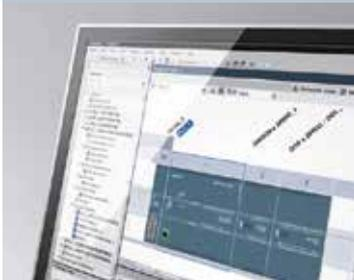
Web Server integrado en la CPU, con plantillas predefinidas. De esta manera se puede visualizar el estado de la CPU, diagnóstico y tabla de variables.
