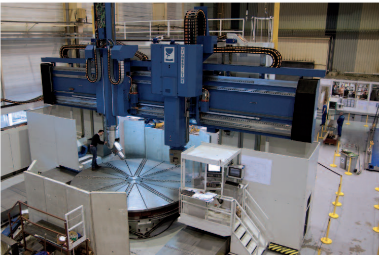
Cette fraiseuse conçue pour le secteur de l'aérospatial embarque un plateau de tournage de 5 mètres de diamètre.
