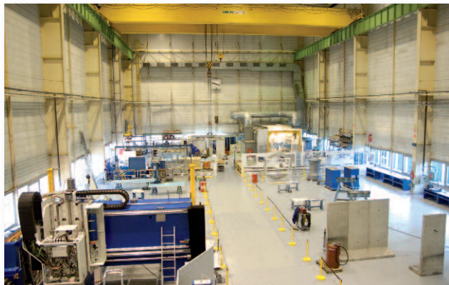
A Albert, Fives Forest-Liné occupe un vaste hall de fabrication de 14 mètres sous crochet.
