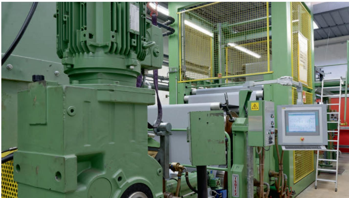
Bei insgesamt 19 Linienantrieben wurden die alten Gleichstrommotoren durch energieeffiziente Asynchronmotoren ersetzt.
