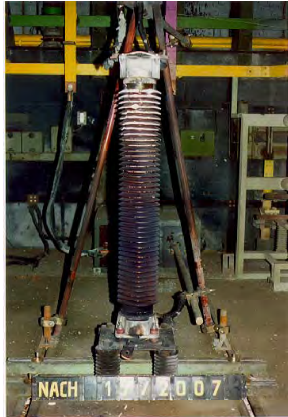
Bild 25: Ableiter mit Porzellangehäuse nach einer Kurzschlussprüfung mit Bemessungskurzschlussstrom (63 kA, 200 ms). Das Gehäuse ist, bis auf einige gebrochene Schirme, intakt geblieben.
