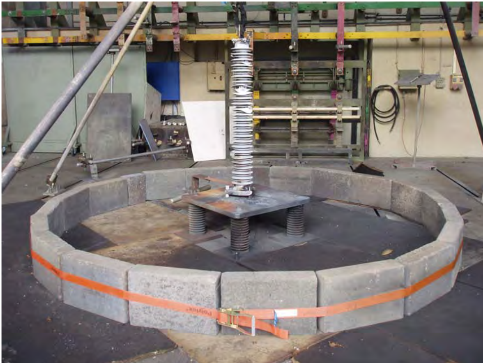
Bild 23: Ableiter mit Kunststoffgehäuse im "Käfig-Design" nach einer Kurzschlussprüfung mit Bemessungskurzschlussstrom (65 kA, 200 ms). Das Gehäuse ist aufgerissen, jedoch mechanisch unversehrt. Gut zu erkennen ist in diesem Bild der Prüfaufbau. Nähere Information dazu unter Kurzschlussprüfungen im Anhang.
