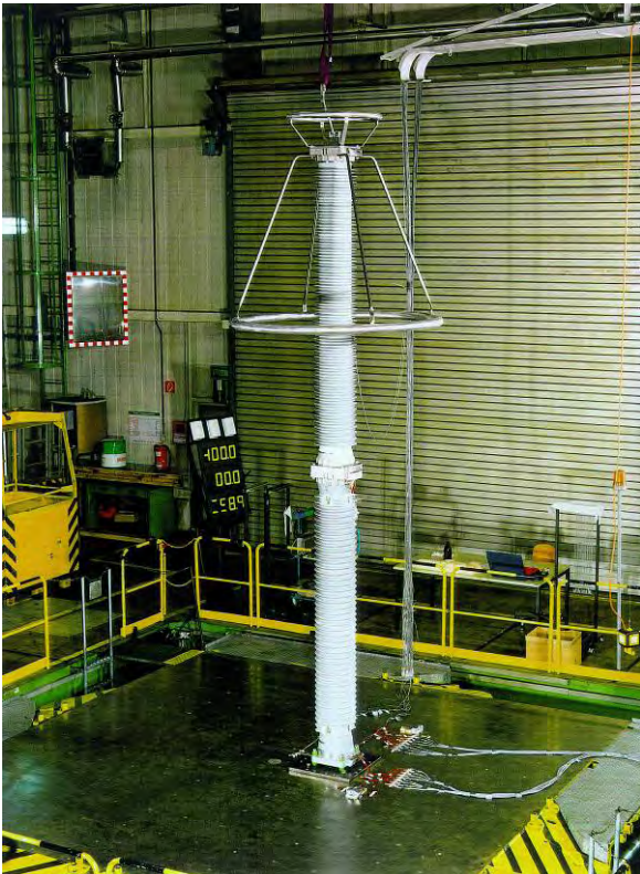
Bild 22: Ableiter mit Kunststoffgehäuse für ein 550-kV-Netz während einer Erdbebenprüfung auf dem Schwingtisch
