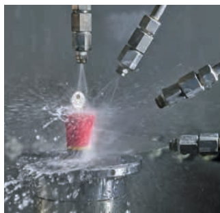
Test med högtryck för IP69K.
