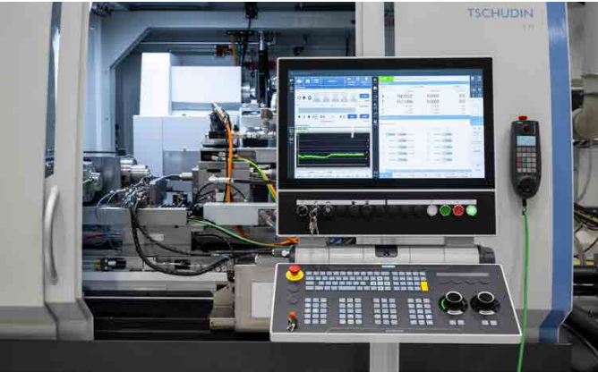
Einfache Bedienung: Auf dem HMI von Siemens lassen sich mehrere Bedienoberflächen – auch von Drittanbietern – übersichtlich darstellen.
