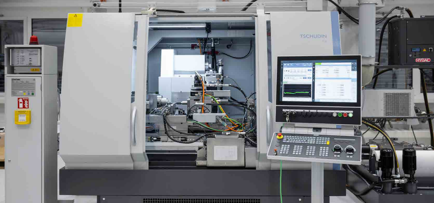
Die Kellenberger T1000-Rundschleifmaschine von Kellenberger steht für die präzise und schnelle Einzweck-Fertigung und wird in der Regel im Betrieb nicht umgerüstet.
