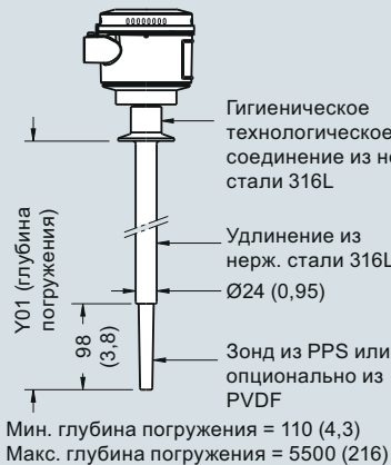
Удлиненная гигиеническая версия Гигиенический фитинг (7ML5632 и 7ML5642)
