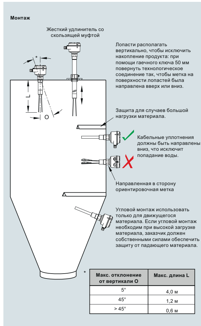
Монтаж SITRANS LVS100, размеры в мм (дюймах)
