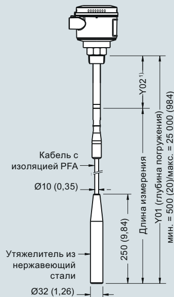
Версия с кабелем, с изоляцией Резьбовое соединение (7ML5651 и 7ML5661)
