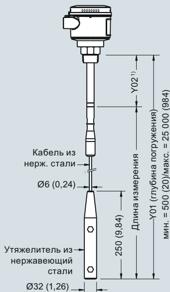
Версия с кабелем, без изоляции Резьбовое соединение (7ML5651 и 7ML5661)
