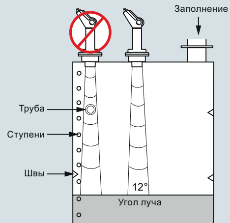
Монтаж The Probe
