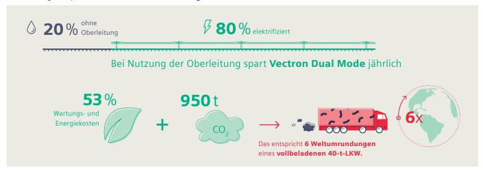
\*bei einer durchschnittlichen jährlichen Laufleistung von 150.000 km und 4.000 Betriebsstunden pro Güterlokomotive
