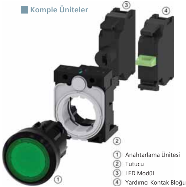
Komple ünite dizaynı
