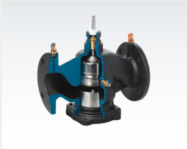
Mit den neuen Kombiventilen VPF44.. erneuert Siemens das Angebot an Kombiventilen (PICV). Die Ventile der Produktfamilie VPF44.. sind grosse PICVs mit Flanschverbindung und können als Direktersatz der Ventile der Reihe VPF43.. verwendet werden. Der zentrale Unterschied ist, dass bei den VPF44.. neu drei Messpunkte vorhanden sind. Somit kann der effektive Volumendurchfluss bei der Inbetriebnahme, während des Betriebs und für Betriebsanalysen jederzeit bestimmt werden.
