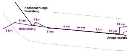
Abbildung 3: Verlauf von Hochspannungsleitung und Rohrleitung
