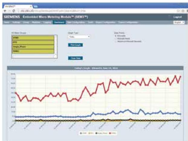
Le SEM3 inclut maintenant un tableau de bord du contrôleur. La mise sous tendance simultanée de plusieurs points permet à l'utilisateur de comparer les consommateurs d'énergie et d'affiner leurs systèmes ou d'identifier des cibles d'anomalies aux fins de correction.
