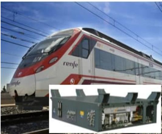
Conforman la parte del equipo eléctrico y electrónico necesario para la alimentación y regulación de la velocidad de los motores de tracción. La fabricación de convertidores consta del montaje de todos sus componentes, pruebas finales y embalaje y expedición.
