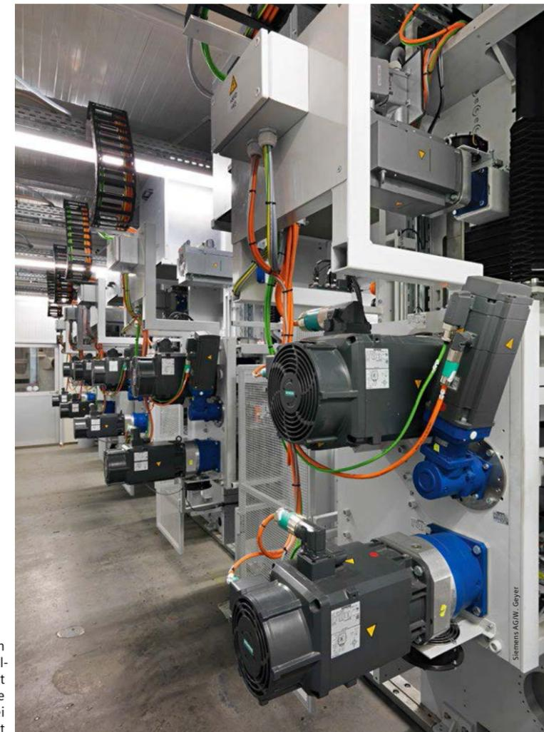
Stapel und ein präzises Einschleusen in den Druckprozess sorgt, und die Drucklängenkorrektur APM, die Toleranzen in der Drucklänge der einzelnen Klischees ausgleicht. Das perfektionierte Zusammenspiel dieser speziellen Funktionen ermöglicht eine Ausbringung von 11.000 bis zu 20.000 Bögen pro Stunde bei Durchlaufgeschwindigkeiten von bis zu 300 m/min. Bei alledem sind sämtliche Abläufe – vom Einrichten über den Regelbetrieb bis zur Wartung – einfach und intuitiv zu bedienen.
