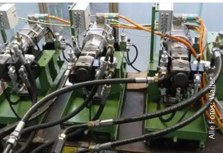
Im Gegensatz zur konventionellen Ventilhydraulik wird bei der Servopumpe die Energie des Antriebsmotors direkt auf den hydraulischen Presszylinder übertragen. Die Servomotoren liefern also nur so viel Energie, wie in der jeweiligen Phase des Pressprozesses benötigt wird.
