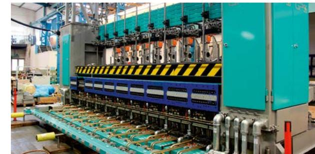
IS-Maschine für die Produktion von Flaschen und Gläsern sämtlicher Formen und Größen.
