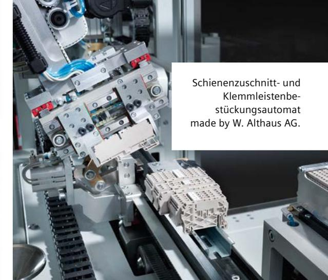
Schienezuschnitt- und Klemmleistenbestückungsautomat made by W. Althaus AG.
