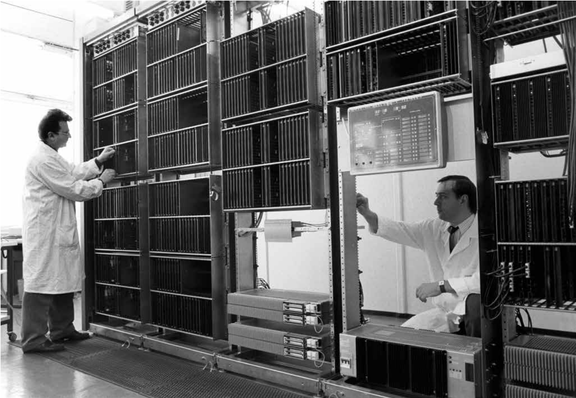
A Telefongyárban a diagnosztizálásra felállított Siemens EWSD telefonközpontot tesztelik, 1990
