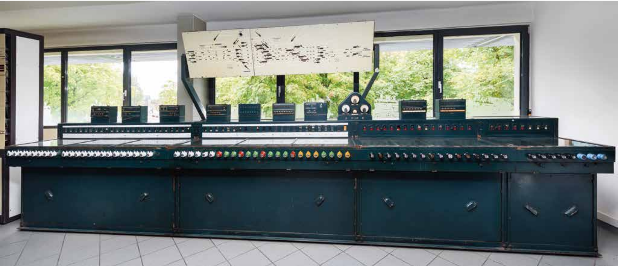
Siemens gyártmányú VES állomási elektrodinamikus biztosítóberendezés, amely a Komáromi vasúti állomáson működött 1936 és 2007 között (Vasúttörténeti Park)
