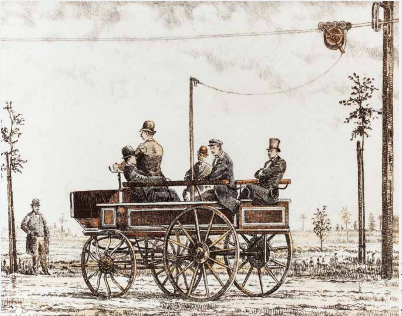
Az Electromote, a trolibusz őseinek prototípusa, Berlin, 1882
