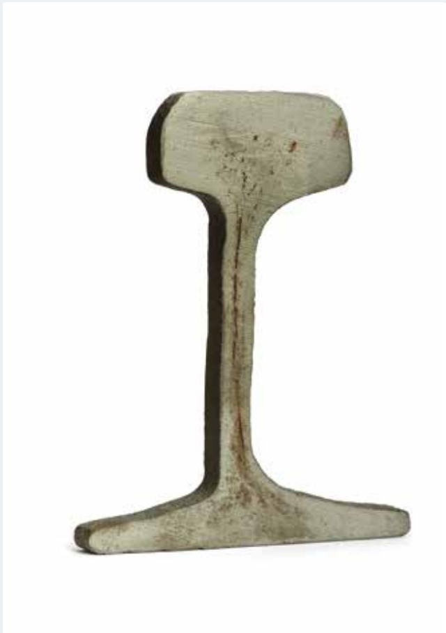
A Millenniumi Földalatti Vasútnál használt aszimmetrikus sín metszete, amelyet kizárólag ennél a vasútnál alkalmaztak, 1896
