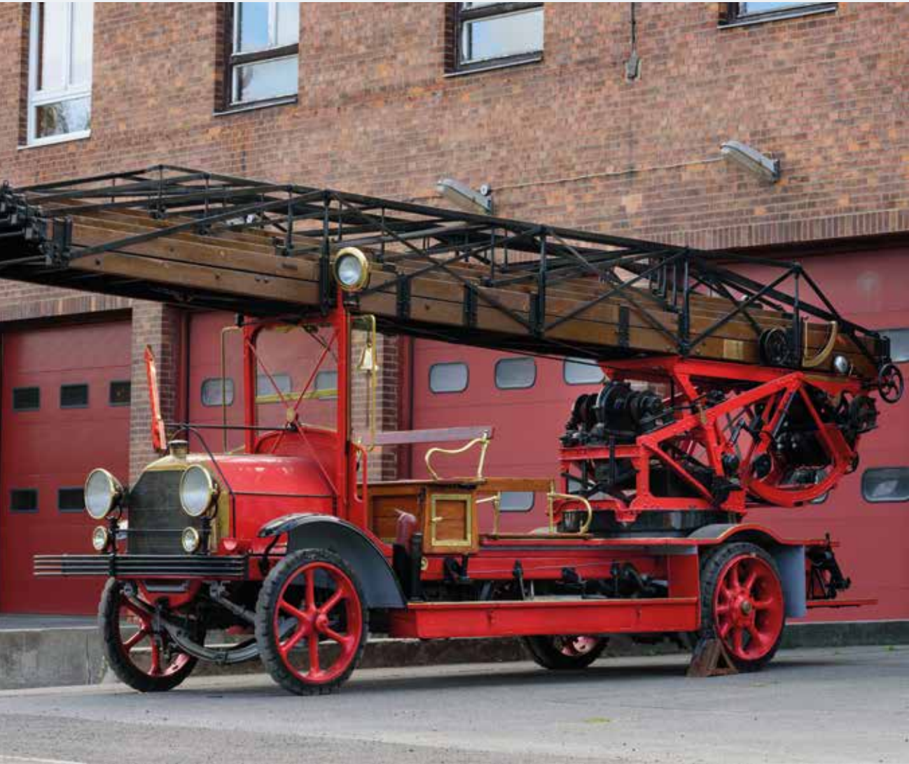
Tűzoltóautó 1914-ből, Austro-Daimler Magirus gépezetes tololétrával, amelyhez a Siemens gyártotta az elektronikát (A Katasztrófavédelem Központi Múzeumának tulajdona)
