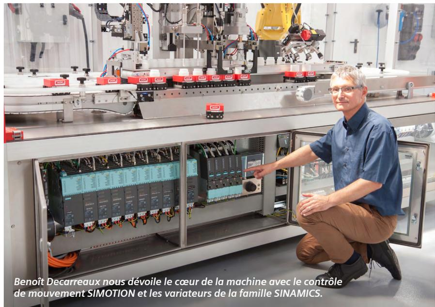
Benoît Decarreaux nous dévoile le cœur de la machine avec le contrôle de mouvement SIMOTION et les variateurs de la famille SINAMICS.
