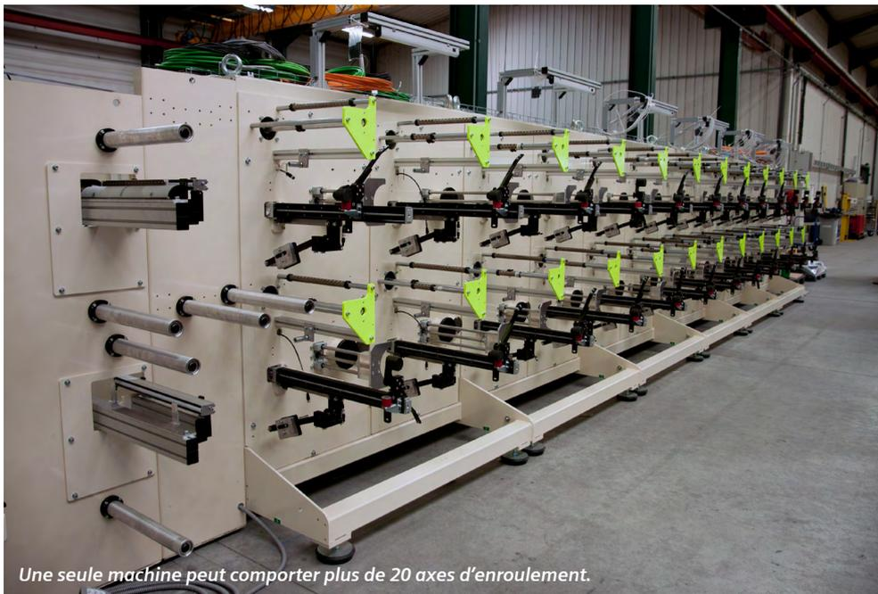
Une seule machine peut comporter plus de 20 axes d'enroulement.
