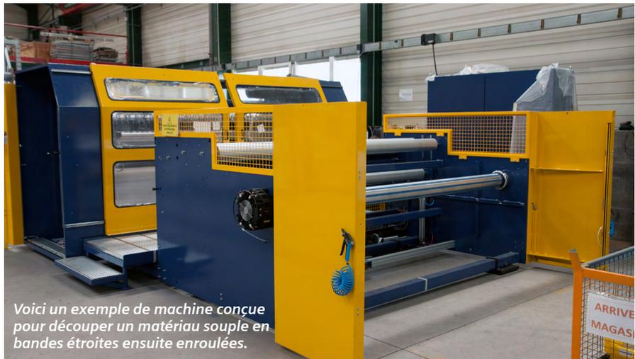
Voici un exemple de machine conçue pour découper un matériau souple en bandes étroites ensuite enroulées.
