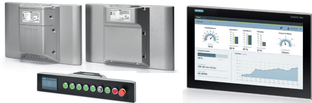
SIMATIC IFP1900 PRO / IFP2200 PRO, SIMATIC ITC 1900 PRO / ITC 2200 PRO e SIMATIC IPC477E PRO 15"/19"/22" para montagem em suportes e braços de apoio; Unidades de extensão opcionais de 12"-22"
