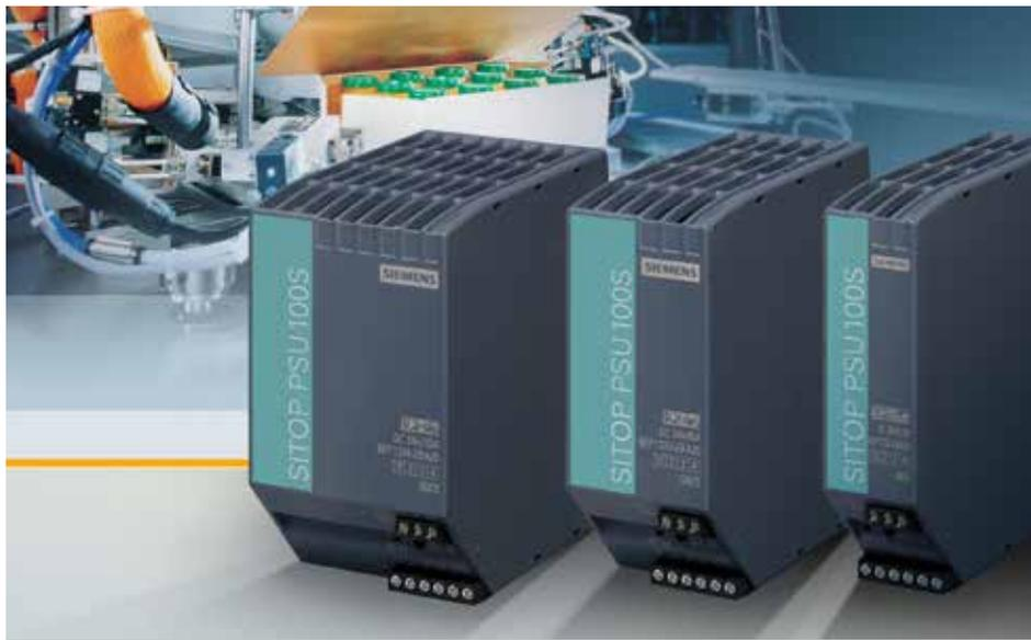
Alle Geräte können für fünf Sekunden pro Minute den 1,5-fachen Nennstrom für einen problemlosen Anlauf von Lasten mit hohem Strombedarf bereitstellen. Die 24 V-Varianten liefern bei Umgebungstemperaturen bis 45 Grad Celsius sogar dauerhaft 120 Prozent Nennstrom.
