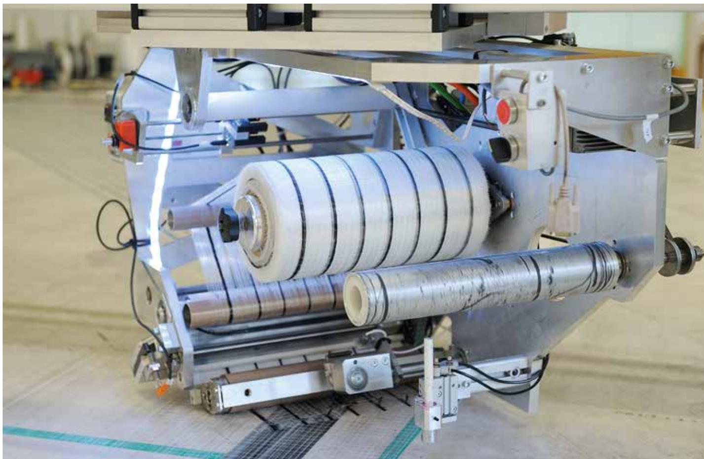
Für die Herstellung von Segeltuch aus Carbon-Verbundfasern werden mikrofeinen Fäden zu Fasern aus Verbundwerkstoff zusammengewirkt und auf eine Spule gezogen.
