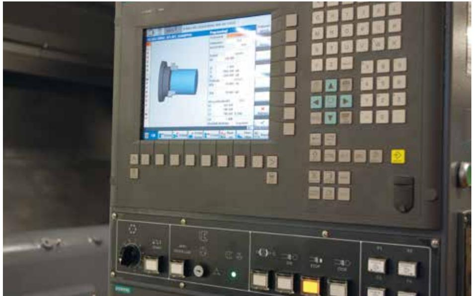
Farbige Grafiken vom Arbeitsraum mit Werkstück und animierte Simulationen der programmierten Bearbeitung sorgen für optimale Prozesssicherheit beim Fertigen individueller Gewindespindeln.
