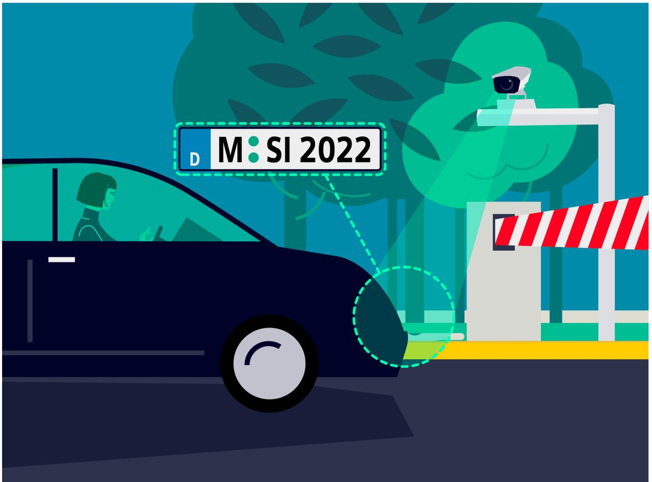
Sobald sich ein Fahrzeug der Einfahrt eines Geländes nähert, erfasst die Sicherheitskamera Attribute des Fahrzeuges wie Fahrzeugtyp, Farbe, Hersteller und Fahrzeugmodell. Zudem erkennt die Kamera das Nummernschild sowie Gefahrgutkennzeichen. Nach erfolgreicher Nummernschilderkennung und Überprüfung im System wird die Schranke geöffnet und die Einfahrt auf den Parkplatz gewährt. Bei der Ein- und Ausfahrt werden
