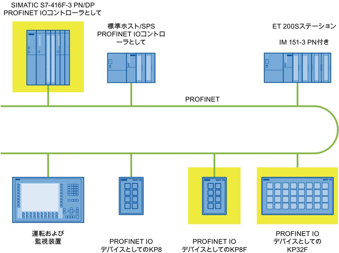
この例では、各 PROFINET IO デバイスが、単一の PROFINET IO コントローラを使用して通信します。PROFIsafe のデバイスは、ここで F-PROFINET IO コントローラと排他的に通信します。
