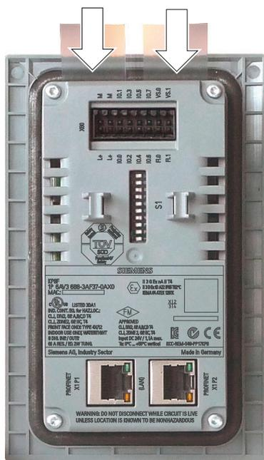
取り付け時、取り付けの材料の厚さが 3.5 mm 以下の場合、ラベルストリップが挿入できます。材料の厚さが大きければ、ラベルストリップを変更する場合、HMI デバイスの分解が必要になります。
