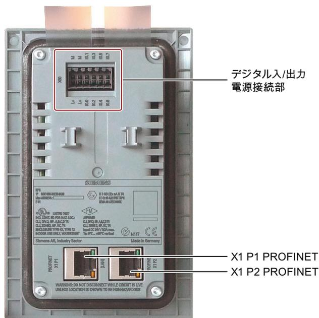
KP8 とは対照的に、KP8Fは、デジタル入/出力用および電源接続用の 16 ピンコネクタを備えています。インターフェースの説明については、「インターフェースの概要 (ページ 114)」セクションを参照してください。
