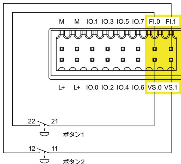
HW Configにある[センサーの評価]の各設定を遵守してください - 「フェイルセーフのプロパティの設定 (ページ 90)」セクションを参照してください。
