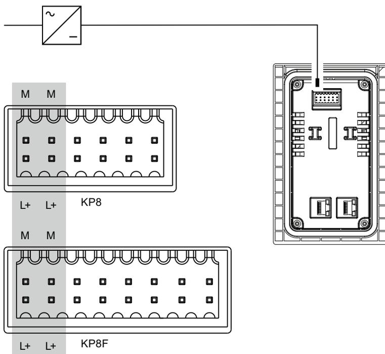
下図に、KP32F の電源への接続を示します。
