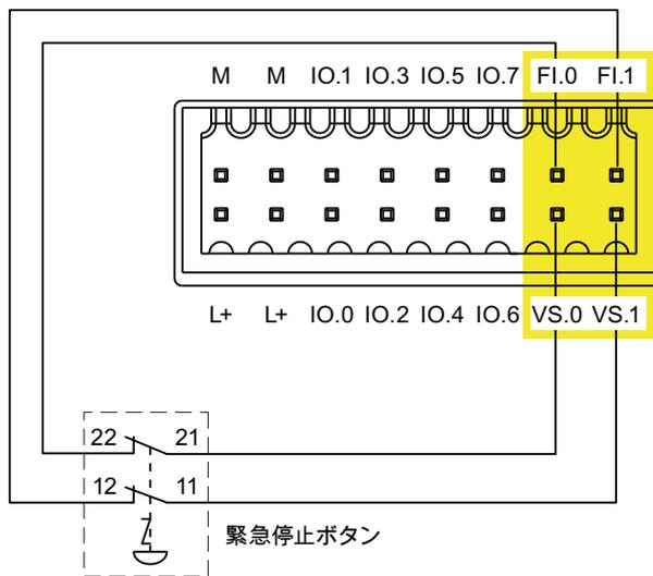
[EMERGENCY STOP]ボタンは、等価なブレーク接点として接続される必要があります。HW Configにある[センサーの評価]の関連設定を遵守してください - 「KP8F - フェイルセーフのプロパティの設定 (ページ 77)」セクションを参照してください。
