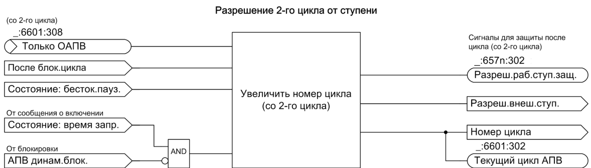
Рисунок 6-247 Логическая схема работы функционального блока Разрешение работы ступени для 2-го и последующих циклов АПВ.
