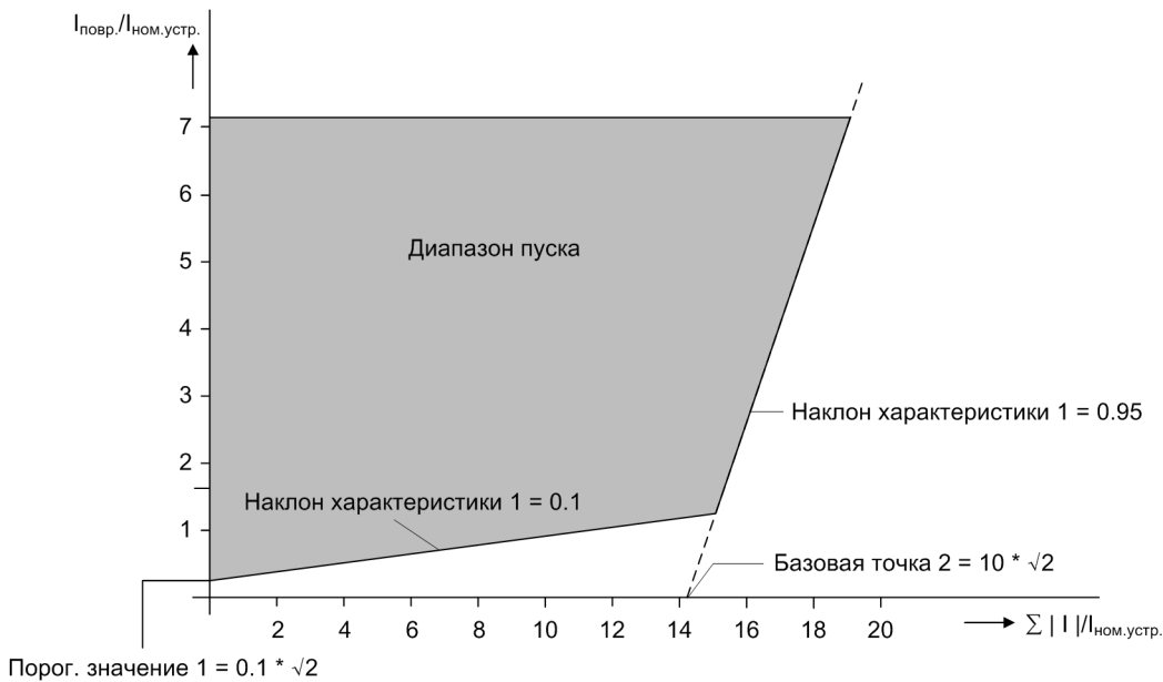
Рисунок 8-36 Характеристика функции мониторинга внутренних АЦП устройства
