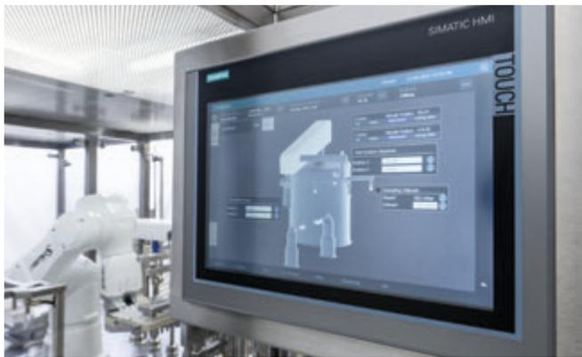
Die Entwickler von Zellwag haben das Bedienelement der Anlage an die Siemens-Optik angepasst. Zusammen mit dem TIA Portal und dem Siemens Mobile Panel vereinfacht das einheitliche Erscheinungsbild dem Personal die Arbeit.
