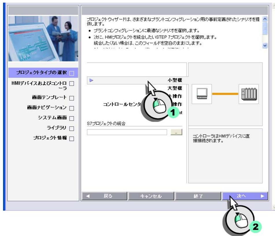
4. "OP 77B"HMI デバイスを選択します。PLC として事前定義された "SIMATIC S7 300/400" を使用します。
