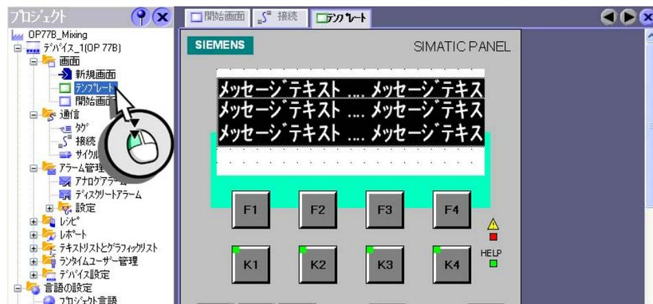
2. 3つの[アラーム]ウィンドウを使用して、テンプレート(1、2)からレイヤーを無効化して、テンプレート(3)を閉じます。
