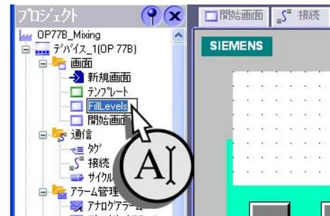
3. 水の占有レベルを表示できる画面に I/O フィールドを挿入します。
