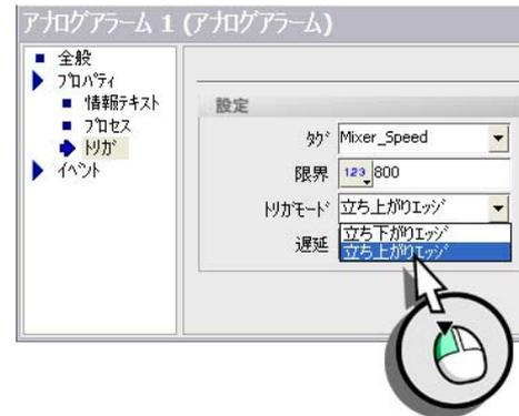
3. 同様に、[ミキサー速度低下]アラームを設定します。アラームは、速度が 400 ("立ち下がりエッジ" 時) を下回ったときにトリガされます。
