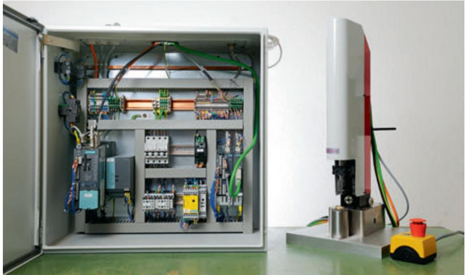
Schaltschrank, Servopresse (hier Konditioniererrohr) und Not-Aus.
