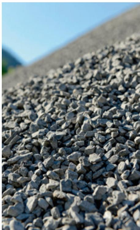
Im Werk Rozloch AG wird das hochwertige Hartgestein «Kieselkalk» zu Gleisschotter, Hartsplitt und Zuschlagsstoffen für die Betonindustrie verarbeitet.
