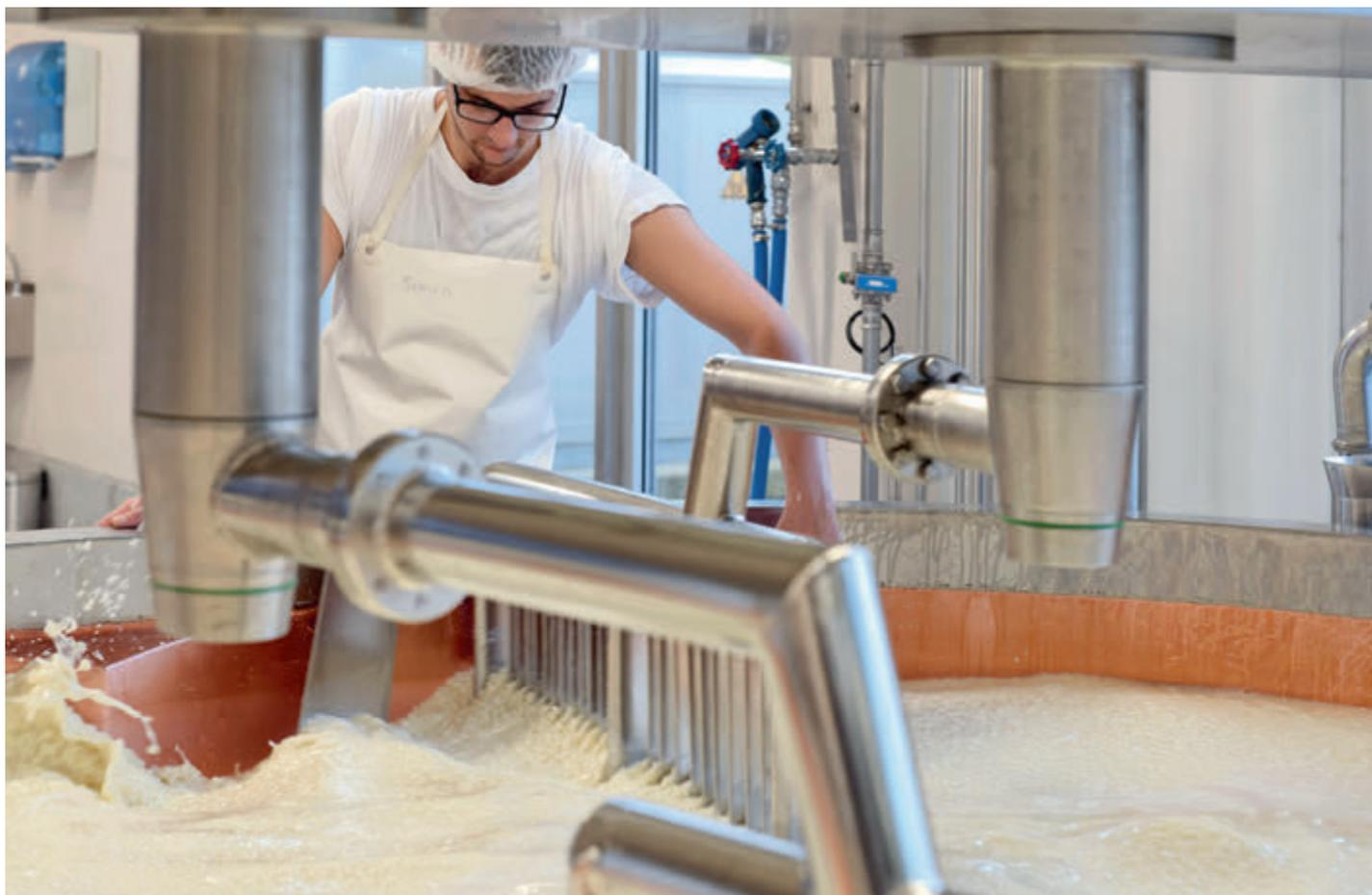
Zu Beginn des Produktionsprozesses läuft die Milch aus dem Vorratstank in einen grossen Bottich mit rund 8500 Liter Fassungsvermögen. Die Flüssigkeit wird nach Zugabe von Lab auf 31,5 Grad erhitzt und mit grossen Rechen gerührt.
