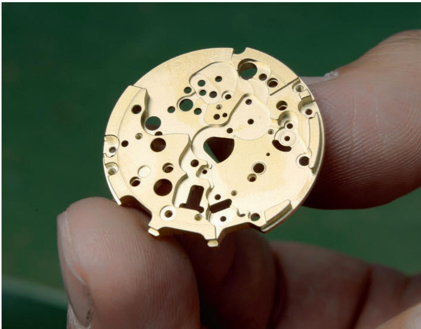
Eine Werkplatte, bei der die Steine (Rubine) mittels Servopresse in die Bohrungen montiert werden.
