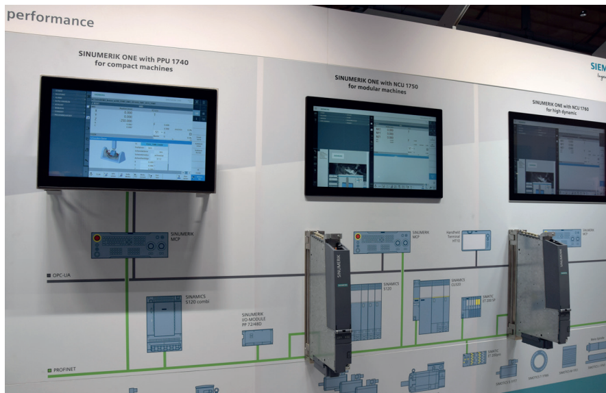
SINUMERIK ONE réelle : de g.à d. PPU1740, NCU1750, NCU1760.
