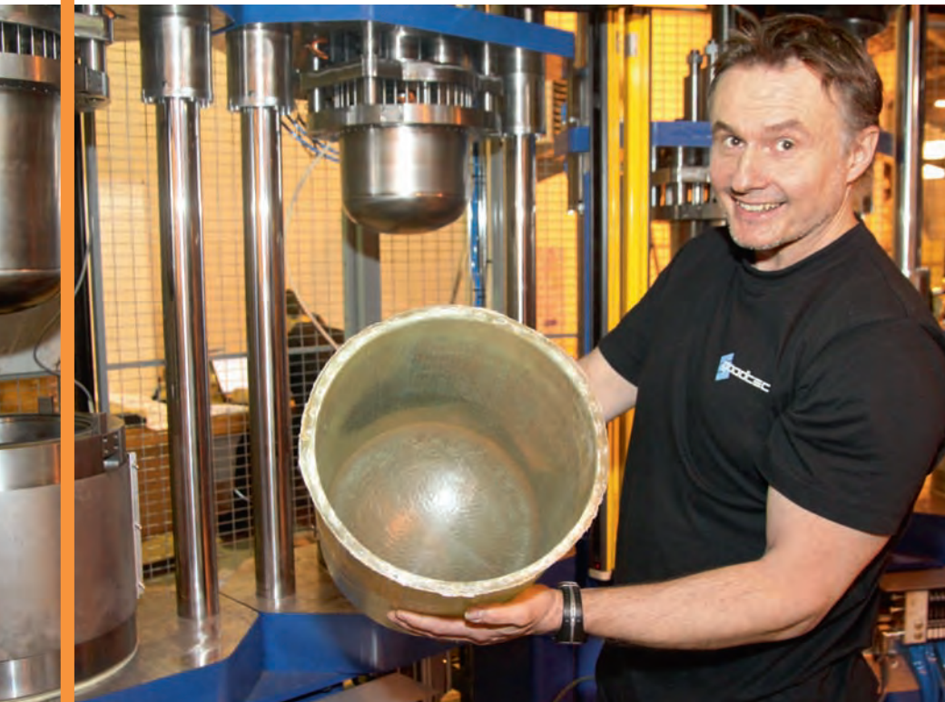
Lätt, säker och genomskinlig: glasfiber lindas ihop till två halvor som sedan skarvas ihop till en hel gasolflaska. Sören Nygren är projektledare på Goodtech Projects & Services, som anlätades av Composite Scandinavia för att ta fram automationskonceptet till produktionslinjen.
