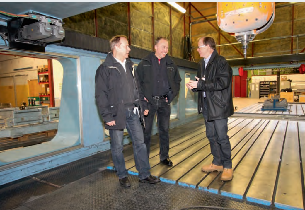
Kjell-Erik Henriksson, Saab, Thomas Andersson, CNC Factory, och Peter Sandström, Siemens, inne i den femaxliga kärnfräsmaskinen med högbyggd portalgantry, portalpress och palettmaskin. Ett bra samarbete företagen emellan ledde fram till ett lyckosamt ombyggnadsprojekt. Tidsplanen hölls, kostnaden blev fem gånger lägre än att köpa en ny maskin och stilleståndstiden för omställningar av maskinen minskade från två veckor till en–två dagar.
