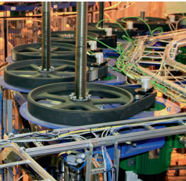
Den 28x28 meter stora och sex meter höga linjen byggdes upp och provkördes i Umeå innan den i maj packades ned och skeppades i sju containrar till Vietnam för att byggas upp på plats under sommaren. Linjen byggdes så att allt skulle gå snabbt att jacka loss.
