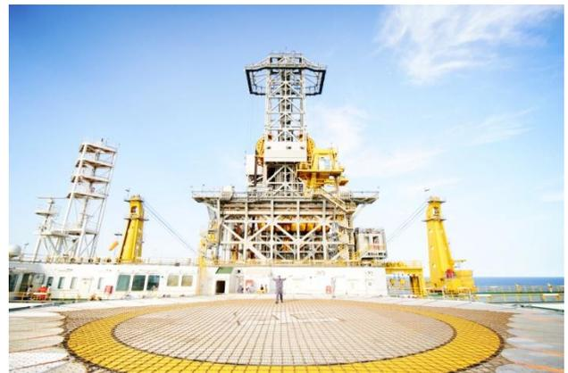
平台的最大作业水深 3658 米，超过泰山高度的两倍，最大钻井深度 15240 米，超过马里亚纳海沟的深度，是全球目前作业水深最深、钻井深度最深的半潜式钻井平台，可作业于全球 99% 的海域。
