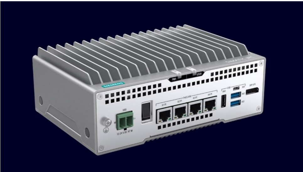
Neu eingeführter Simatic IPC BX-35A mit integriertem Grafikprozessor von NVIDIA
