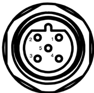
図 4-21 SCALANCE X208PRO の M12 信号用接点
