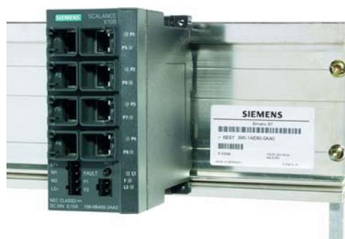
図 5-3 SIMATIC S7-300 DIN レールへの実装
