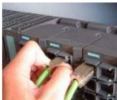
図 5-6 RJ-45 プラグの取り外し
