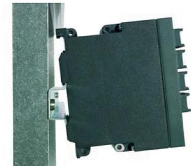
図 5-2 35mm DIN レールからの取り外し
