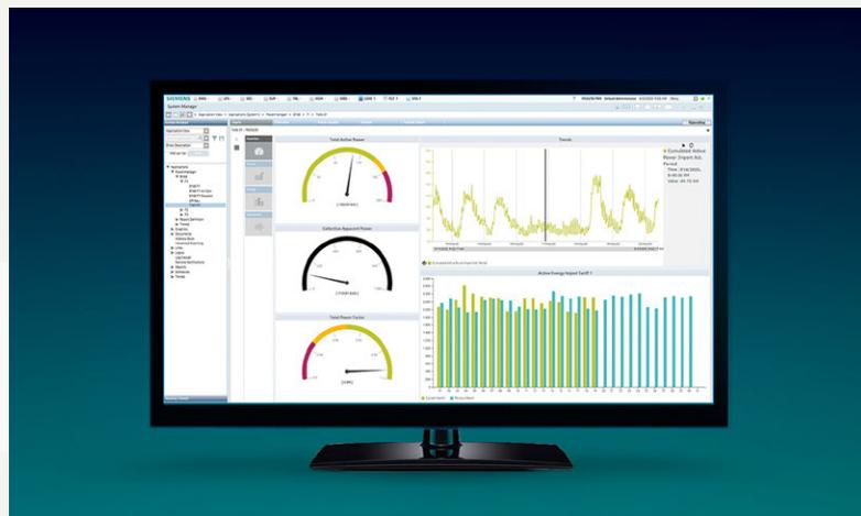
Transparenz für niedrigere Energiekosten und höhere Anlagenverfügbarkeit: Mit der Software Sentron powermanager können Energiemanager und -berater sowie Facility-Manager den Energieverbrauch in Gebäuden und Anlagen überwachen, Lastspitzen identifizieren, den Zustand ihrer Niederspannungsenergieverteilung im Blick behalten sowie Berichte für ein betriebliches Energiemanagement gemäß ISO 50001 erstellen. ■
